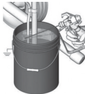
Figura 12 - Acionando a máquina para liberar pressão
